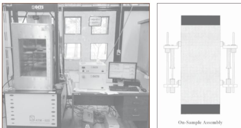
Figura 6. Equipo e instrumentación del espécimen para la ejecución del ensayo número de flujo.
