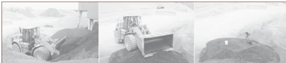
Figura 2. Procedimiento de muestreo de RAP en planta.
